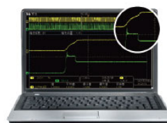
Быстрое нарастание напряжения при запуске, превышение диапазона пускового тока (постоянное напряжение — высокий приоритет, постоянный ток — низкий приоритет, постоянное напряжение превагирует)
