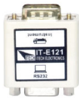
IT-E121 Интерфейс связи RS232, со стандартным кабелем связи RS232 Применимая модель: IT6100, IT6800, IT6322, IT6302, IT8500+, IT8500
