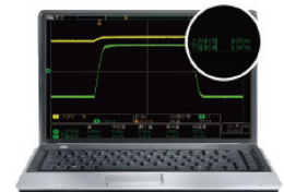
Испытание аккумуляторов на заряд/разряд, плавное переключение, без выбросов (постоянное напряжение — высокий приоритет, постоянный ток — высокий приоритет, постоянный ток превагирует)
