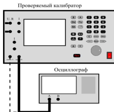
Рисунок 13.10 – Измерительная схема для проверки параметров сигналов специальной формы, воспроизводимых с выхода двухканального генератора
