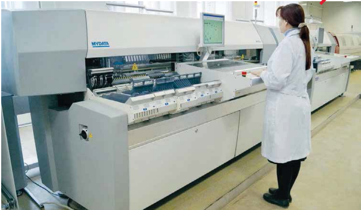
Универсальный установщик SMD-компонентов на печатные платы MY100DX-14 (MYDATA)
