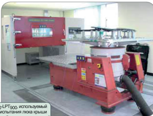
Вибростенд V875LS с перемещением 72 мм и плитой скольжения LPT600
