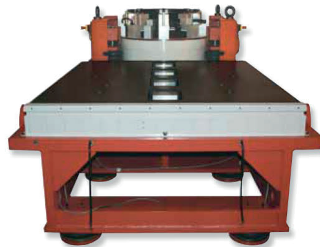
Стол скольжения HBT с демонстрацией роликовых опор вдоль центральной оси
