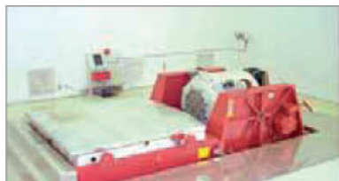
Вибростенд V994 в «чистой комнате»
