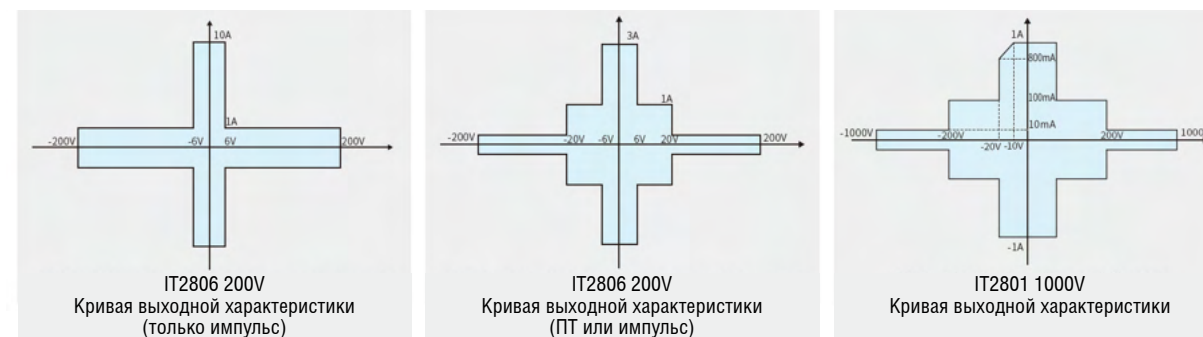
Рис. 4. Динамический диапазон работы источников-измерителей
